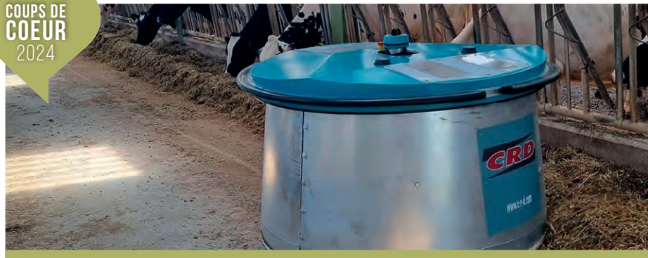
Le robot, parfaitement autonome, se déplace automatiquement le long du couloir d'alimentation sans déranger les animaux et ne nécessite aucune modification dans votre bâtiment.
